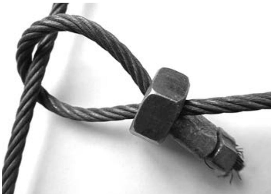
Рис. 2 – Стопор на петле «гаечного» типа.
