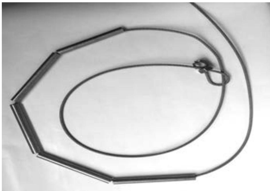
Рис. 1 – Петля с защитными трубками.
